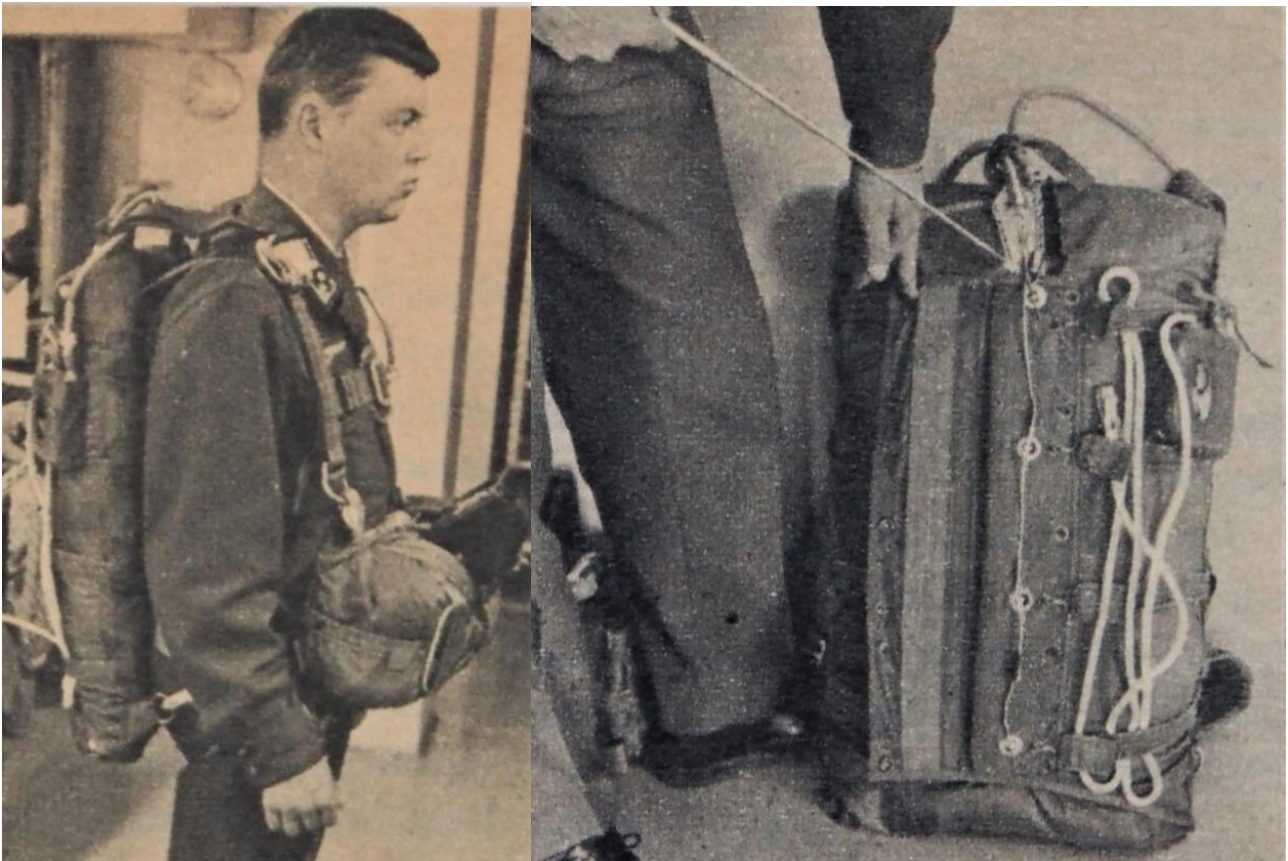
Kuvassa päävarjon läppään asennettuja KAP-3 laukaisimia. Kuvissa näkyvä vaalea hihna vetää uloshypyn aikana laukaisimen varmistussokan ulos. Vasemmanpuoleisen kuvan mannekiini on pitkäaikainen LuKT:n jäsen Heikki Siiröpää. Kuva: Seura 16/1971.
