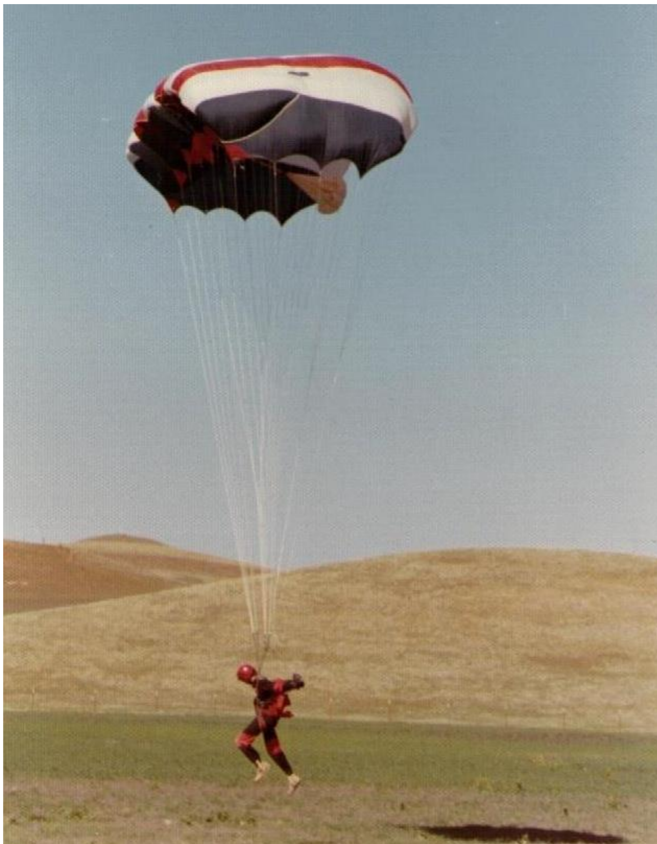
The Pioneer "Volplane" is a high-glide parachute design of the Pioneer Parachute Co., Manchester, Connecticut, U.S.A. Ensimmäiset hyyt patjavarjoilla Suomessa tehtiin tämän tyyppisillä varjoilla. Niistä kahdesta ei kuitenkaan ole olemassa valokuvia. Kuva: https://www.quora.com/What-does-a-parachute-landing-feel-like-Could-even-a-safe-landing-damage-your-body
