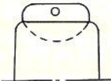
Piirros 6. Vahvennos ja purjerenkaiteen vapaaksi jättäminen
