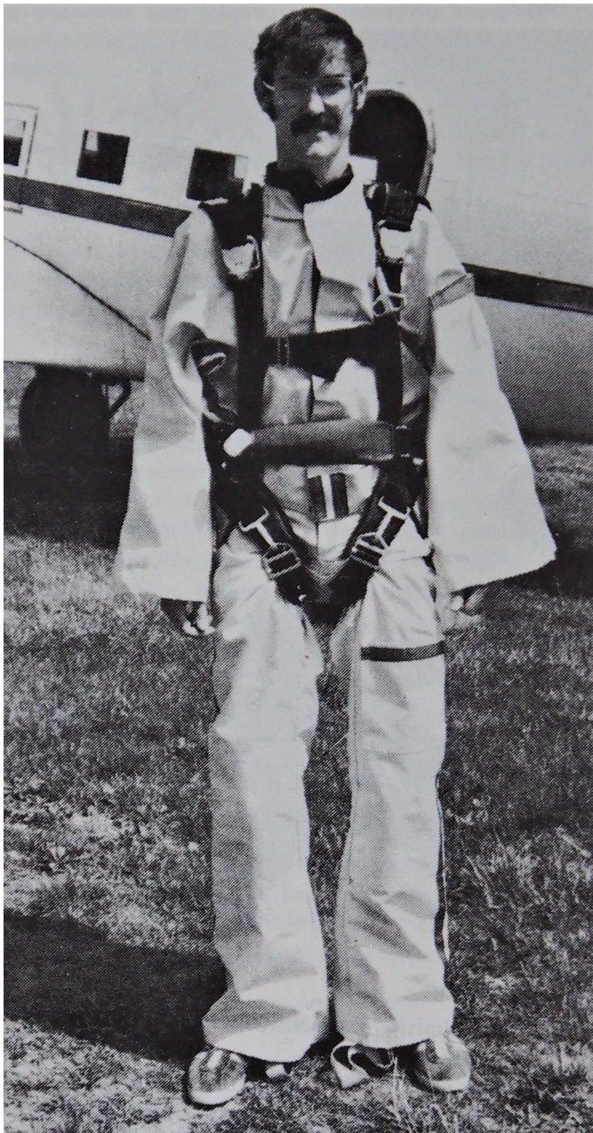
Kuvassa Wonderhog ja kädestä päästettävä apuvarjo vuosimallia 1976. Apuvarjo on sijoitettu mahavyössä olevaan taskuun ja sen päässä on muoviputken pätkä paremman otteen saamiseksi. Kuvan Wonderhogissa on pian vanha-aikaiseksi jääneet metalliset Capewell 1-shot olkalukot. Kuva: Andy Keech via Laskuvarjourheilu
