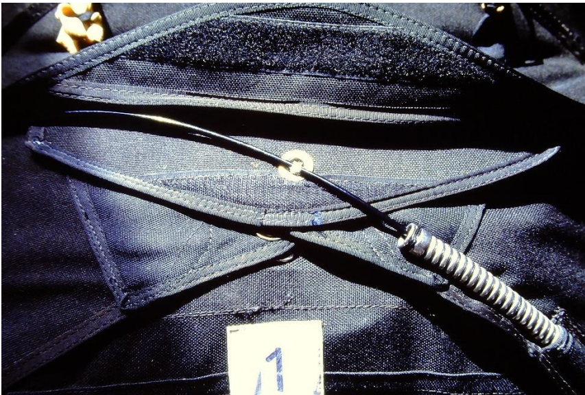
Kuvassa T.S.E: Chaser oppilastandem pakattuna itselaukaisukäyttöön. Muovipäällysteisessä laukaisuvaijerissa ei ollut enää perinteistä sokkaa. Kuva: Eero Kausalainen.
