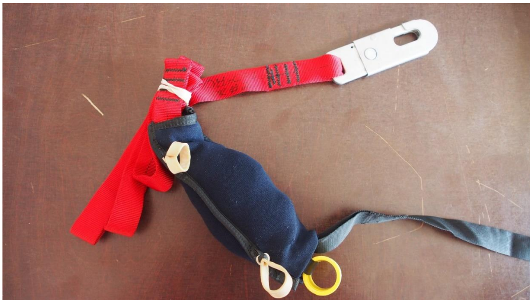
JAD-pakkolaukaisujärjestelmän jatkokehitelmä Tumppu, IIK:n Cessna 206 koneeseen (OH-CSU) sovitettuna, mutta kuvattuna 34 vuotta myöhemmin, kesällä 2020. Konstruktio oli edelleen sama kuin vuonna 1986. Kuva: Eero Kausalainen.
