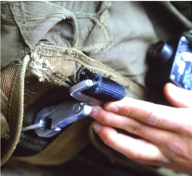
Vasemmassa kuvassa on laskuvarjovarustuksen yhteensopivuuteen liittyvässä tarkastuksessa hylätty rintapakkavarjo, jonka kantohihna on pahoin kulunut. Oikeassa kuvassa on oppilashyppääjän varustukseen kuuluva puukko [tai vastaava teräase]. Tähän aikaan kokeneet hyppääjät
