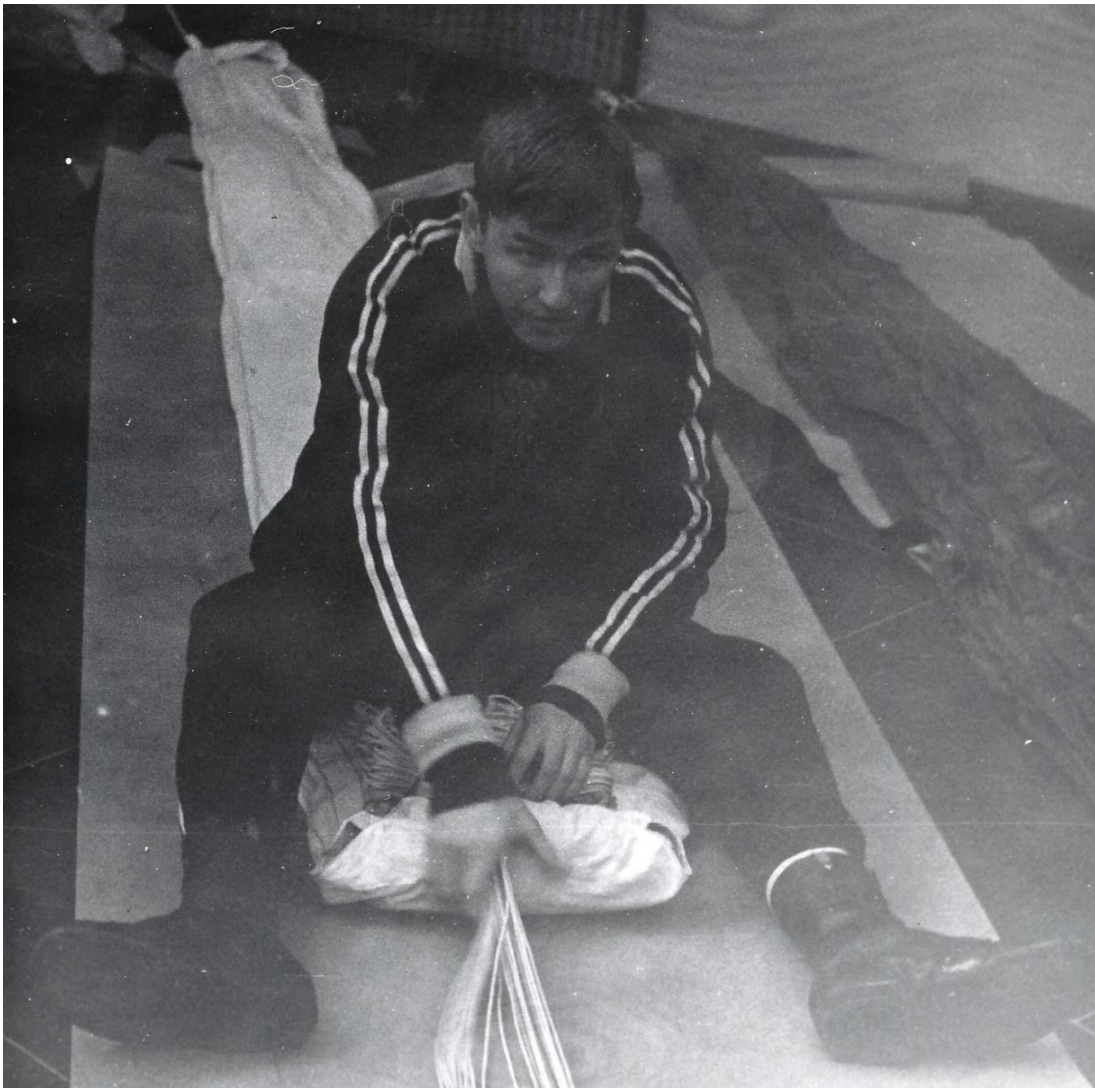
SLK:n hyppääjä punostaa kantopunoksia hidastussukan alapäässä oleviin kumilenkkeihin. Kuva: via SLK
